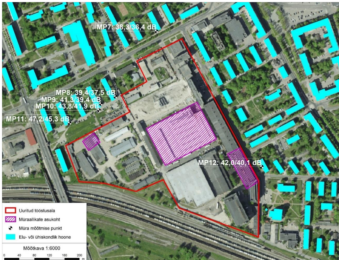
Joonis 5.5. Mõõtepiirkonnad 7-12 – müra mõõtmispunktide paiknemine P. Kerese ja Linda tn tööstuspiirkonna ümbruses (Maa-ameti ortofotol)
